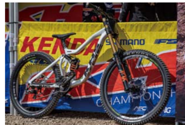
ダウンヒルに使用するレース用バイク。前後200mmのサスペンションを有する。ENDUROモデルと共通の基本設計。
